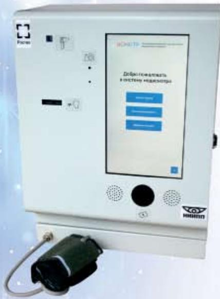
танционного медицинского осмотра. В частности, устройство востребовано для предрейсового осмотра водителей. Комплекс измеряет температуру тела и артериальное давление, проводит тест на наличие алкоголя и психические реакции, позволяет врачу в режиме реального времени с помощью видеокамеры наблюдать за состоянием и реакциями проходящего осмотра. АО «НИИПП» принимает заказы, готово предоставить «Смотр» для опытных производственных испытаний.
